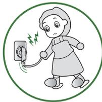
拔插头时请勿牵拉电源线。电源线损坏将导致火灾及触电危险。若电源线已损坏，为防止危险发生，请停止使用，并向购买处或者总部咨询更换电源线。
